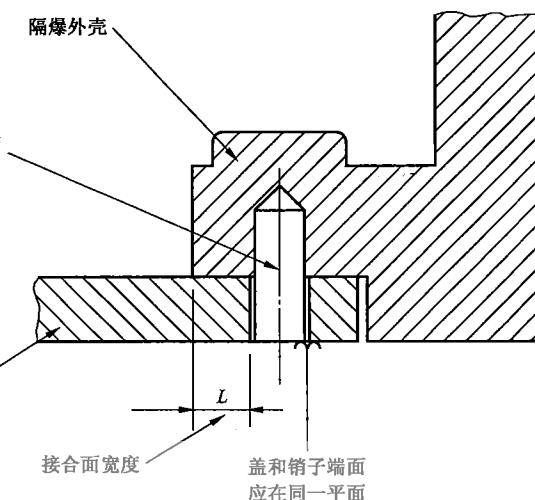
图 1 I 类电气设备平面隔爆接合面结构的间接检查示例
