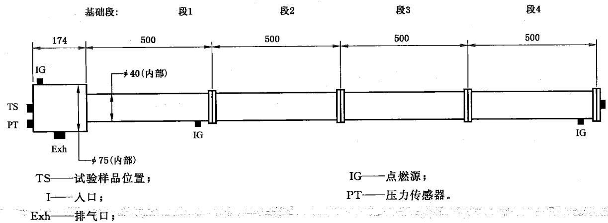
图 21 呼吸和排液装置的部件试验装置
